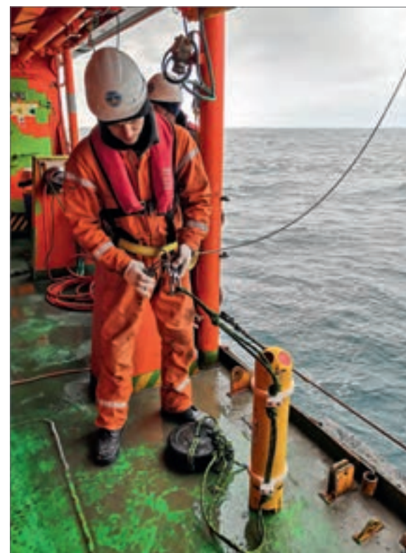
Измерение течений в ходе экологических работ на лицензионном участке «Туапсинский прогиб», 2019 г.
